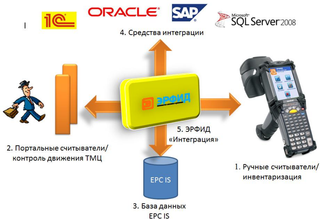
Рис. 1 Состав системы RFID инвентаризации
